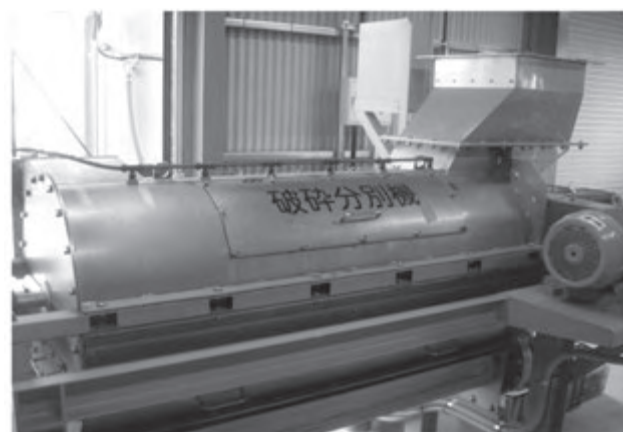
写真1 前処理装置（破碎分別機）
