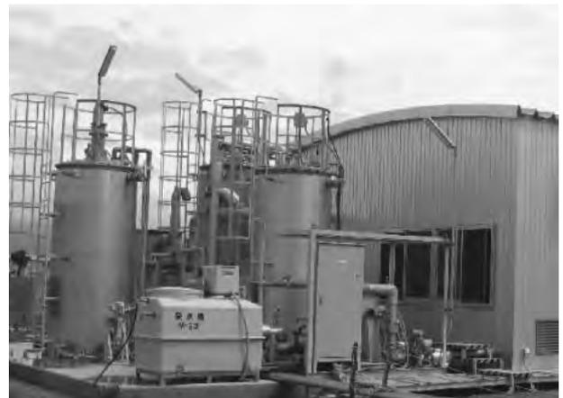
写真2 超高速嫌気性消化の実証プラント
