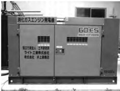
図8 土木研究所が開発した消化ガスエンジン発電機
