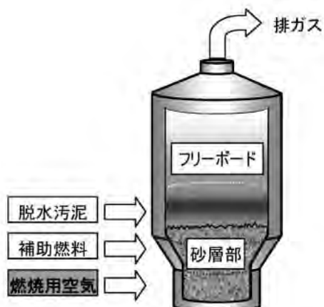
図2 当局で一般的な流動焼却炉の模式図
