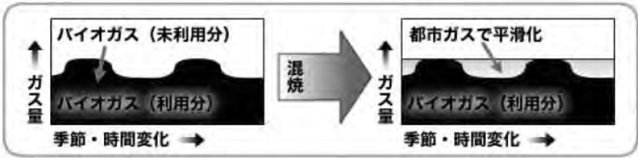
図ー5 都市ガスによるバイオガス利用の安定化（イメージ）
