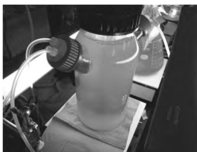
図4 下水処理水による藻類の連続培養試験 (下水処理水中に含まれる窒素・リンを利用してオイル生成能の高い藻類などの培養・資源回収を目指す)
