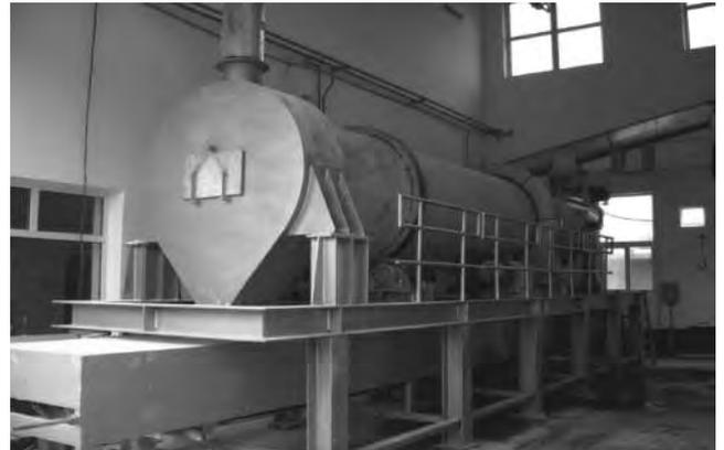
写真3 Fangzhuang 石灰系汚泥乾燥施設
