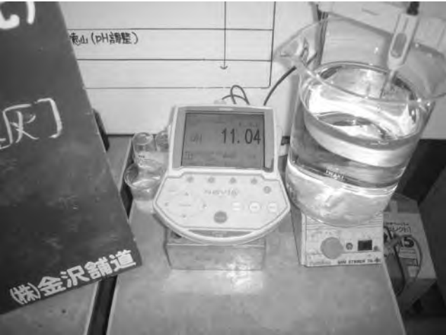
写真－3 強アルカリ性状態安全性評価状況
