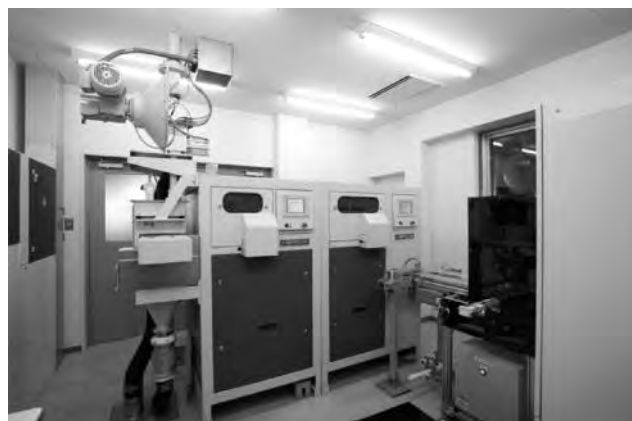
図－5 塩基度分析装置
