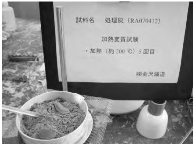
写真一4 対熱安全性評価試験状況
