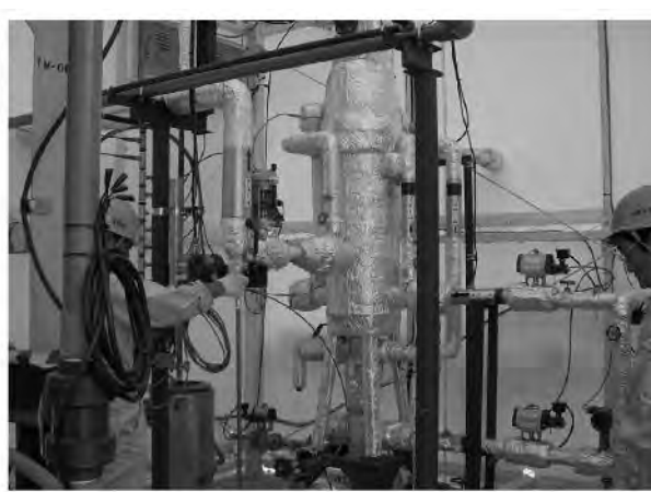
写真3-2 実証プラントの外観（左）、熱可溶化タンク（右）
