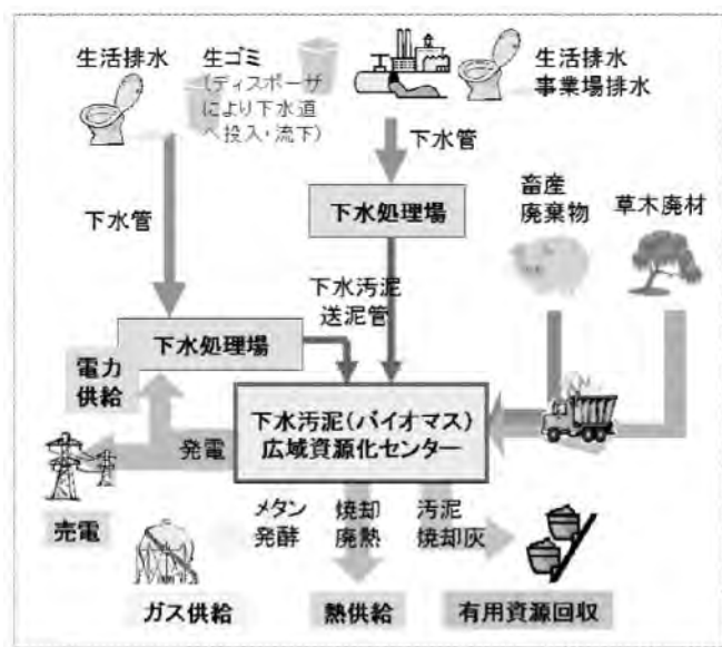
図-1 下水汚泥の資源循環システムの概念と構成要素
