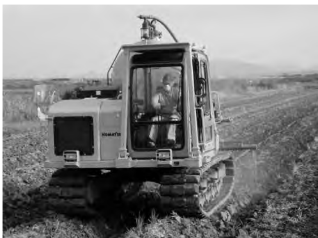
写真一、2 改良スラリースプレッダによる直接施用
