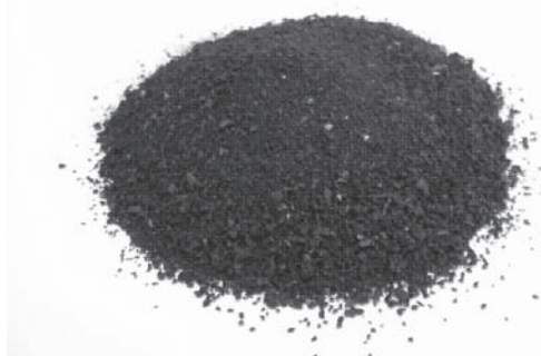
写真3 製造試験で製造された炭化物
