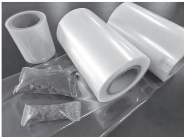
図-1 ロール状バリアフィルムとバリアフィルムで包装された乾燥汚泥
