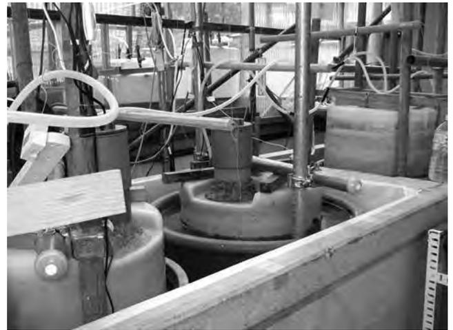
図4 メタン発酵槽とバイオガス貯留タンク
