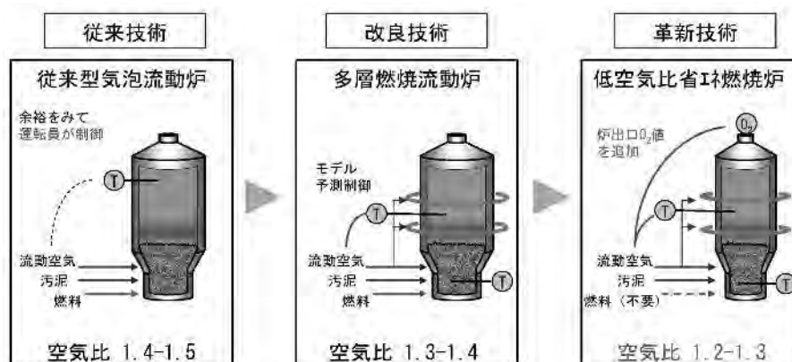
図4 従来型焼却炉と低空気比省エネ燃焼炉の違い
