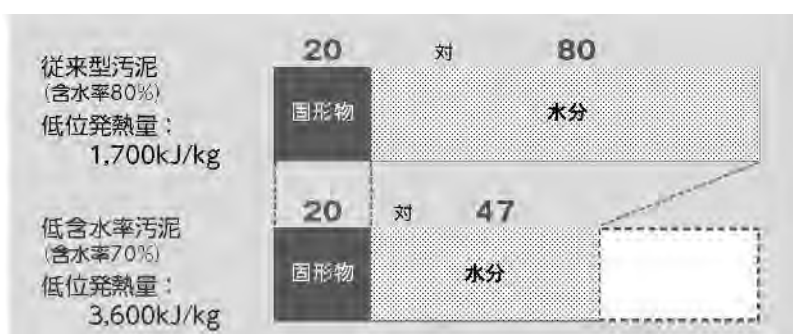
図-4 汚泥低含水率化の例
