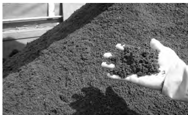
写真3-1 機内二液調質による脱水ケーキ
