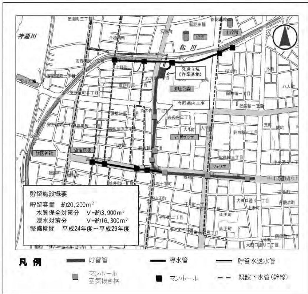
図3.3 松川雨水貯留施設の概要
