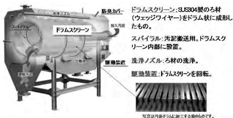
図-11 回転ドラム濃縮機の概要
