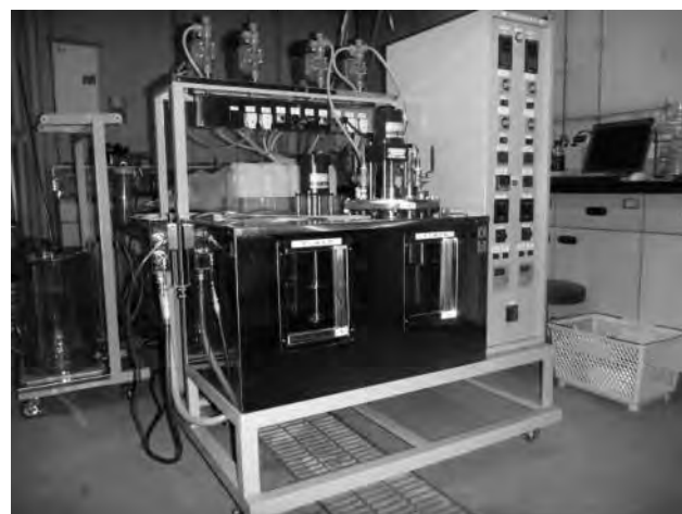
図-6 刈草の下水汚泥混合メタン発酵実験
