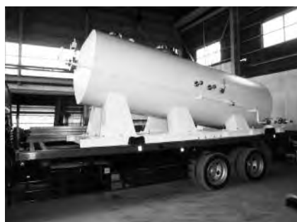
写真-2 筆者製作のメタン吸蔵容器 (容量10m 3 、メタン450m 3 N充填、10トントラックに搭載) 北日本環境エナジー（株）写真提供。
