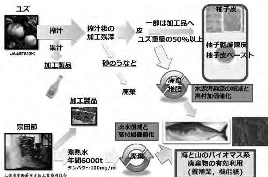
図5 農業系廃棄物のカスケード利用による水質汚染抑制・高付加価値製品創出システム（本図作成：深田陽久）
