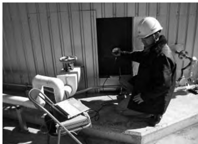
写真2 超音波による堆積物測定状況
