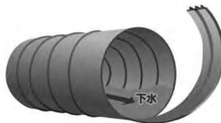
図1 更生工法に合わせた熱回収
