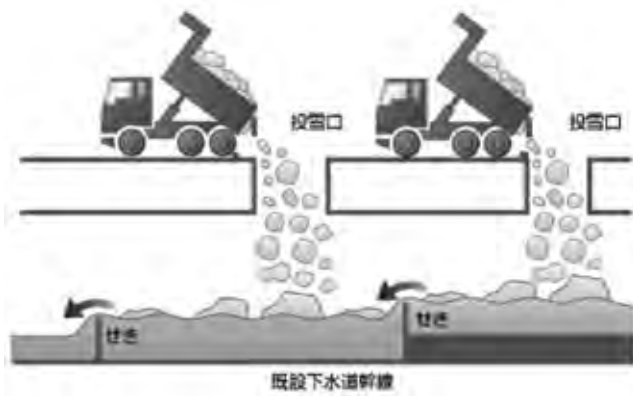
図-4 八軒下水道管投雪施設
