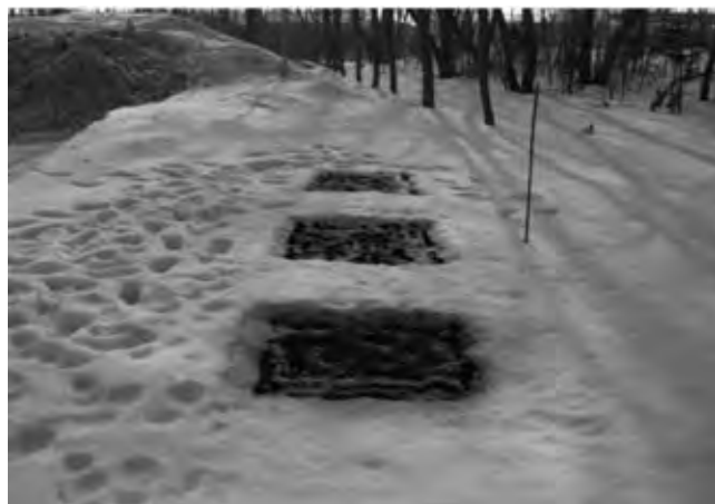
写真6 コンポスト散布による融雪促進試験
