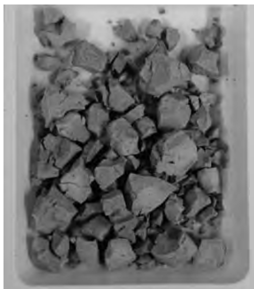
図5 回収された析出物（ヒドロキシアパタイト）の外観
