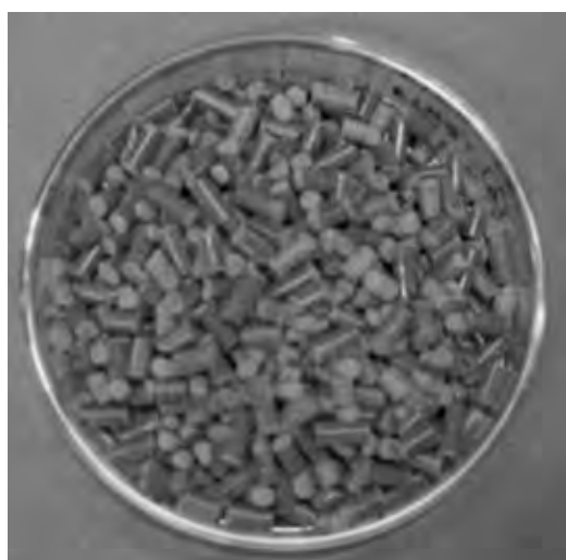
写真2 下水汚泥焼却灰を原料とする新規リン酸資材
