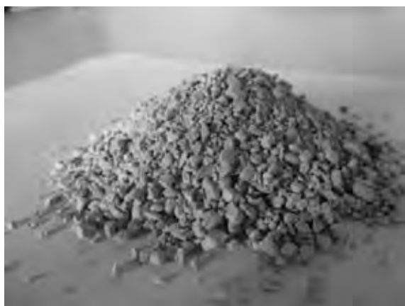
図 1 実証実験に用いた脱リン材 PAdCS ® の外観
