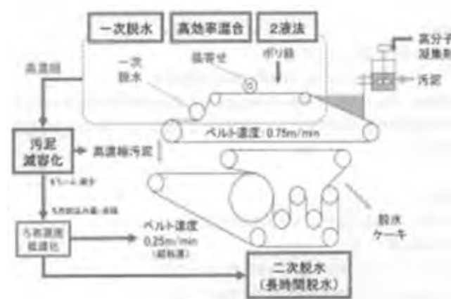
図-2 後注入 2 液型 B P 脱水機概念図
