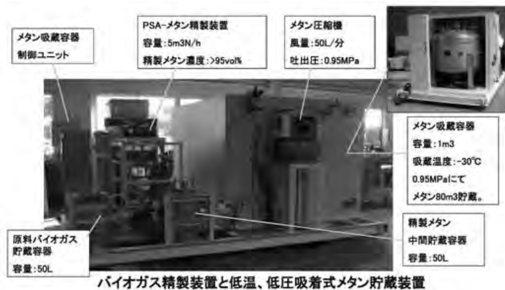
図-5 移動式 バイオガス精製装置と低温・低圧吸着式メタン吸蔵容器
