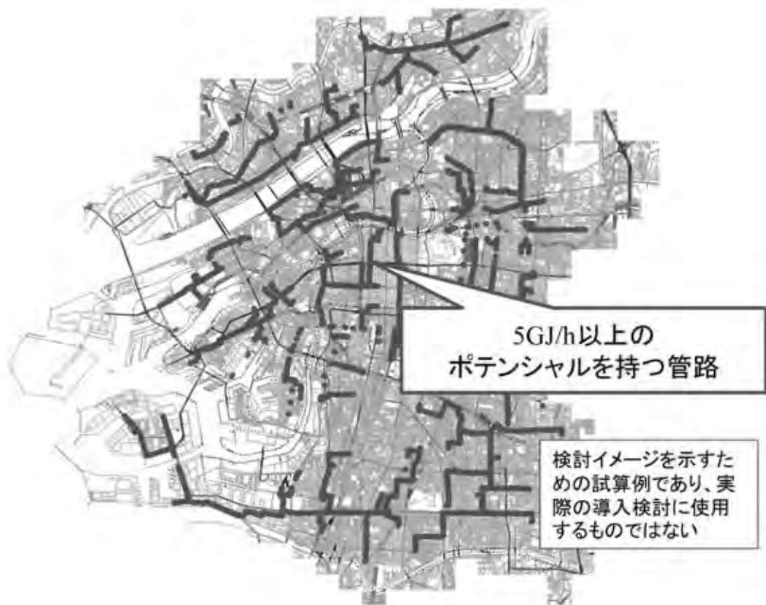
図4 都市内下水幹線における下水熱利用ポテンシャルの試算例
