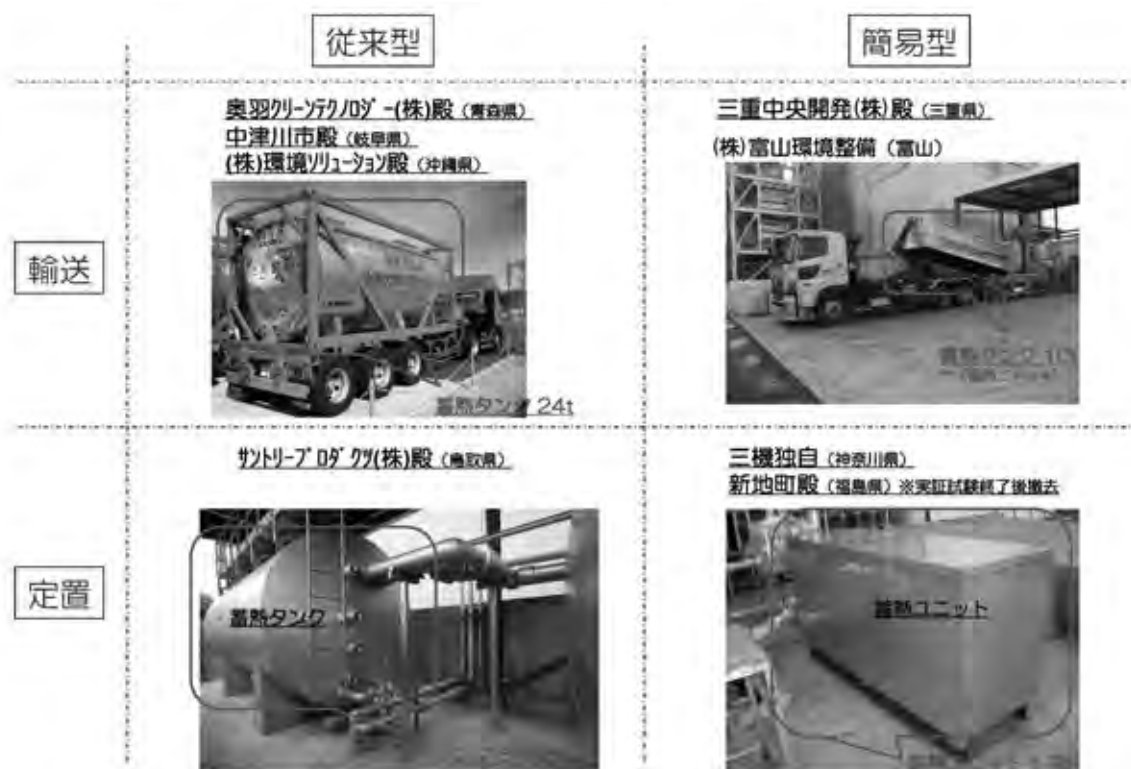
図-2 蓄熱コンテナの利用方法
