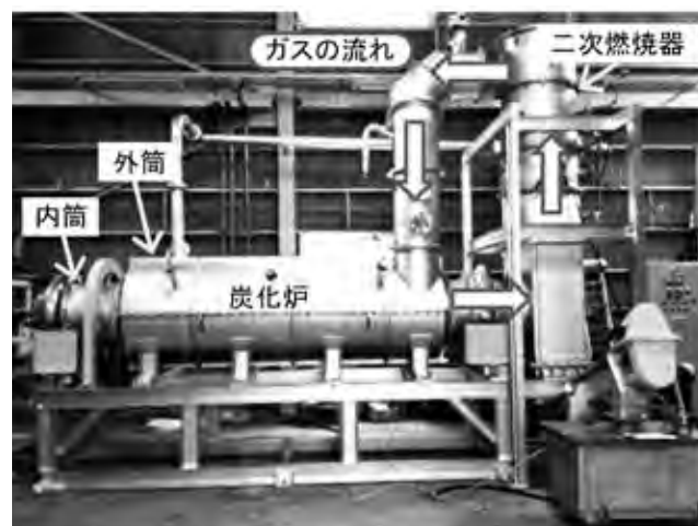
図1 炭化装置外観
