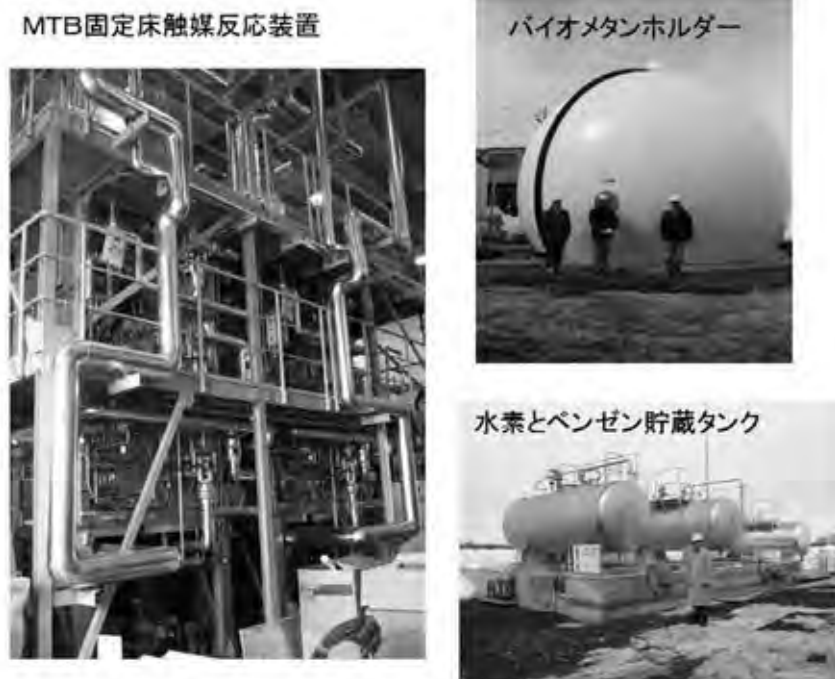
図6 発酵メタンを活用するバイオMTB技術の実証試験でのMTB触媒反応装置およびバイオメタンホルダーと水素・ベンゼン貯蔵タンク
