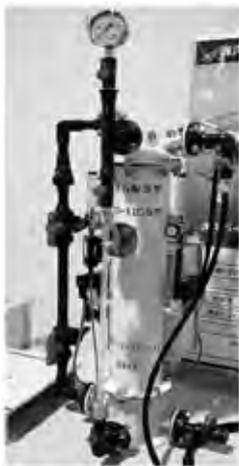
図3 小型気体溶解装置
