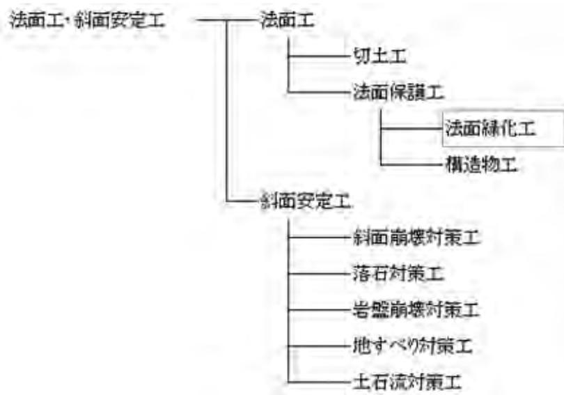
図2 法面工（盛土法面を除く）・斜面安定工の分類
