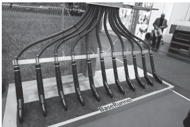
写真 12 土壌中に液肥散布するためのノズルの例
