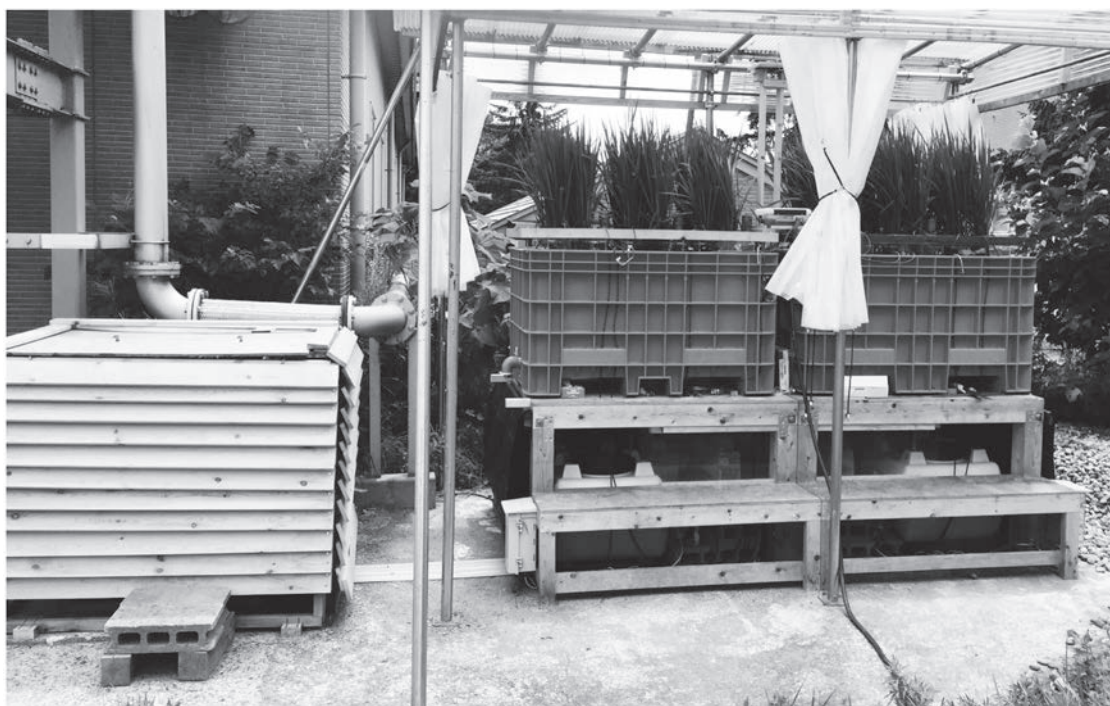
写真 1 水田模型の外観（左の木枠で囲まれた原水タンクからの下水処理水が、右の水田模型へと供給される）
