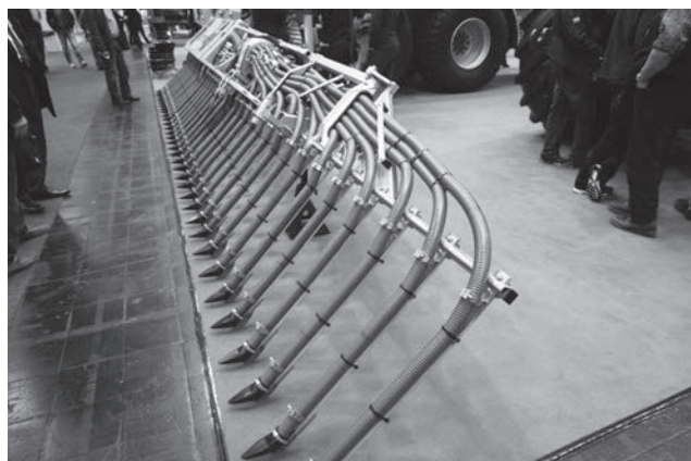
写真11 土壌中に液肥散布するためのノズルの例
