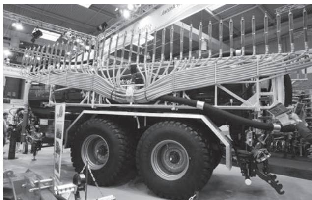
写真10 散布ノズルがタンク横に格納される様子
